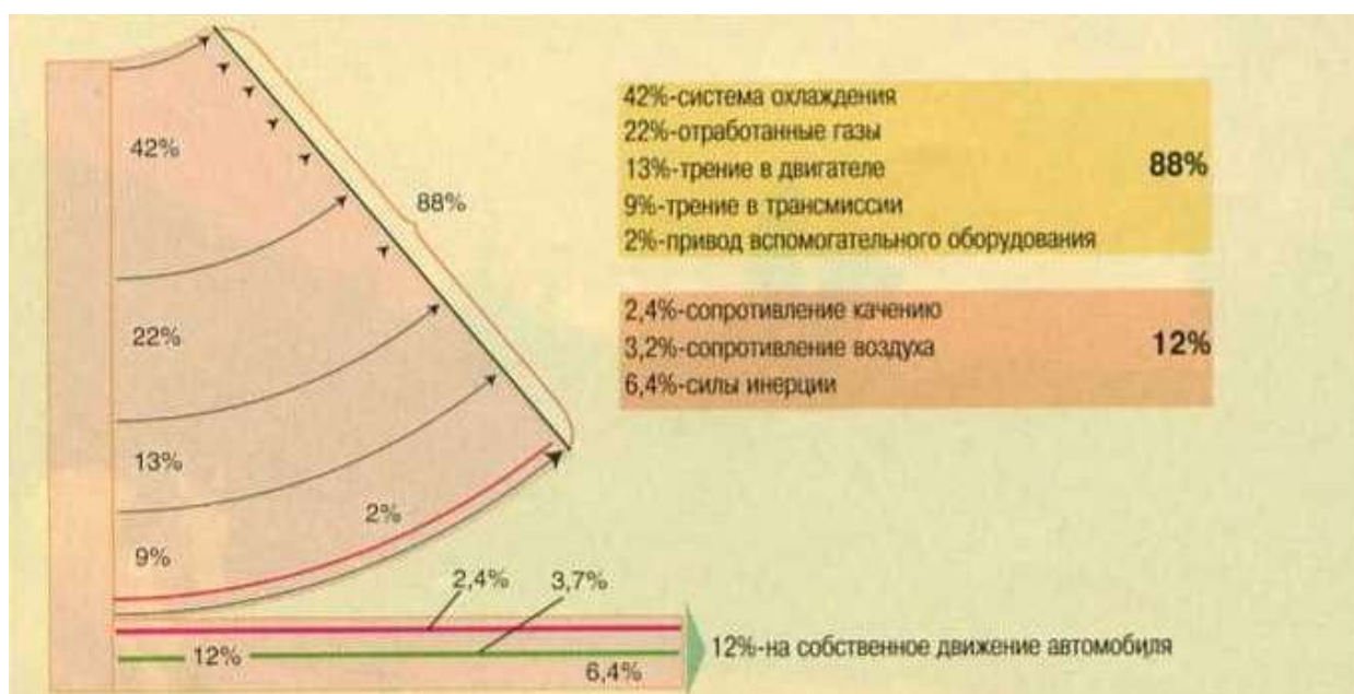
Иллюстрация неэффективности использования бензина в автомобиле.
